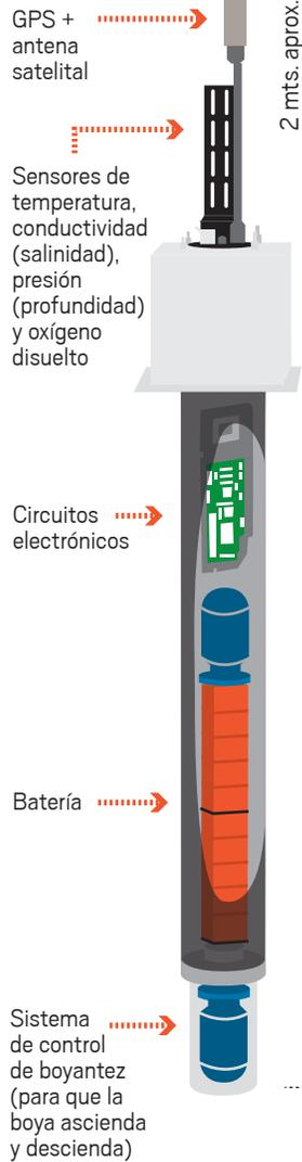
**ARGO** es un programa internacional que utiliza boyas perfiladoras para medir variables como la temperatura, salinidad y oxígeno disuelto entre 0 y 2000 m (o 6000 m) de profundidad.
